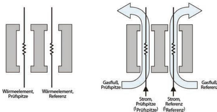
**LINKS:** Dualanalyse wird dadurch erreicht dass sich die Wärmeelmente in getrennten Flußräumen angebracht sind
