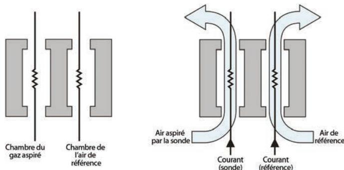
**A gauche :** Le système comprend deux thermistances placées dans deux chambres distinctes, l'une pour l'air ambiant, l'autre pour le gaz aspiré par la sonde.
