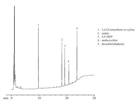
30m, 0.53mm ID, 0.42 $\mu$ m Rtx\*-CLPesticides2 (cat.# 11340). Inj.: 1 $\mu$ L of 50pg/ $\mu$ L standard. Oven temp.: 120°C (hold 1 min.) to 300°C @ 9°C/min. (hold 10 min.); Inj. temp.: 250°C; ECD temp.: 300°C; Carrier gas: helium.
